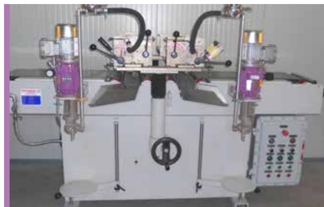
Barnizadora: variador K2 en bomba dosificadora
