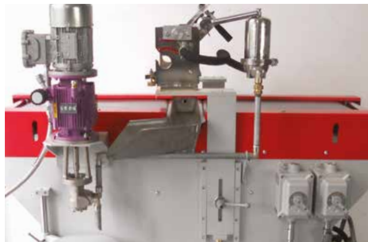
Barnizadora: variador K2 en bomba de dosificación (ambiente Atex)
